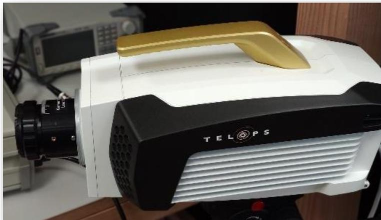
*Figure 16: FAST M350 Thermal Camera*
